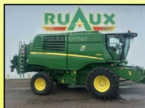
John Deere T660, 2020, pracovní záběr 9 m, motor 1350 h, buben 819 h, 6 vytrásadel, přívěs, pěch, klimatizace, cena bez DPH: 230 000 €
