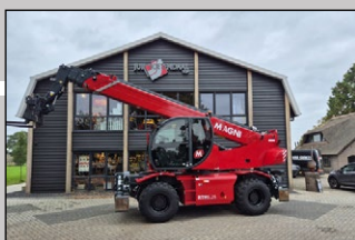
MAGNI RTH 6.26 (26 m, 6 ton), 2025 r., nowy, widły, klima, przygotowany pod kosz, sterowanie zdalne
