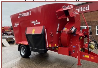
Trioliet Solomix P2 2000, podwójny podajnik ślimakowy, wał odbioru mocy 540, skontaktuj się aby uzyskać pełną specyfikację i cenę
