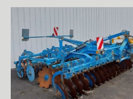
LEMKEN RUBIN 10/400 KU, 2011, ciągniony, składanie hydrauliczne, 32 talerze, szer. 4 m, wał tylny MSW600, cena netto: 16 500 €
