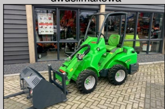
Avant 420, ładowarka (1080 kg), 2017, 1075 h, wysokość podno- szenia 2,7 m, nośność podno- szenia 600 kg, łyżka i widły
