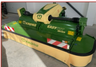
Krone Easycut F320 CV, kosiarka dyskowa ze zgniataczem pokosty, montaż przód
