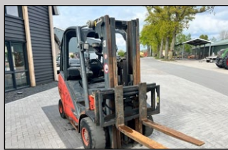
LINDE H35, wózek widłowy na gaz, 2014 r., 15300 mth, maszt triplex, wolny wysuw, przesuw boczny
