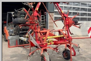
Lely 675, przetrząsarka, 2000 r., szerokość robocza 6,75 m, 6 wirników
