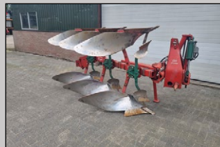
KVERNELAND 120, pług, 3 skiby, szerokość robocza 1,5 m
