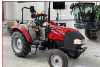
Farmall 55A, 2x2, składany pałąk bezpieczeństwa, mechaniczna skrzynia biegów, hydraulika tylna, opony 340/85 x 28
