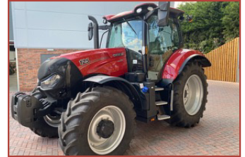
Caselh Maxxum 125 Active Drive 4 Autoshift, pełne zawieszenie, obciążniki przednie, 50 km/h, opony 600/65 x 38
