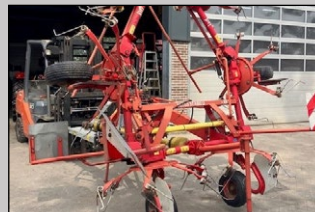
Lely 675, przetrząsarka, 2000 r., szerokość robocza 6,75 m, 6 wirników
