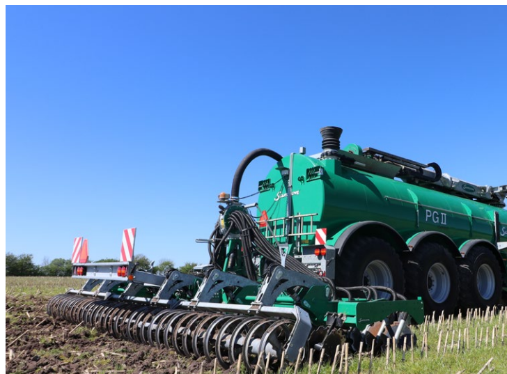
[ Przeznaczony do cięższych gleb model CDx, o szerokości roboczej 8 m ]
