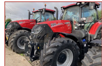
CaselH Puma 200, PowerShift, podnośnik przedni, GPS, 50 km/h, opony 650/65 x 42
