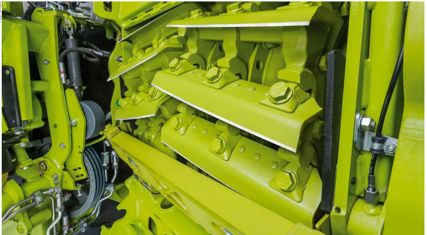
Nowo opracowane noże V-FLEX mają szereg wyjątkowych właściwości w zakresie ochrony przed zużyciem, optymalizacji przepustowości i płynności pracy
